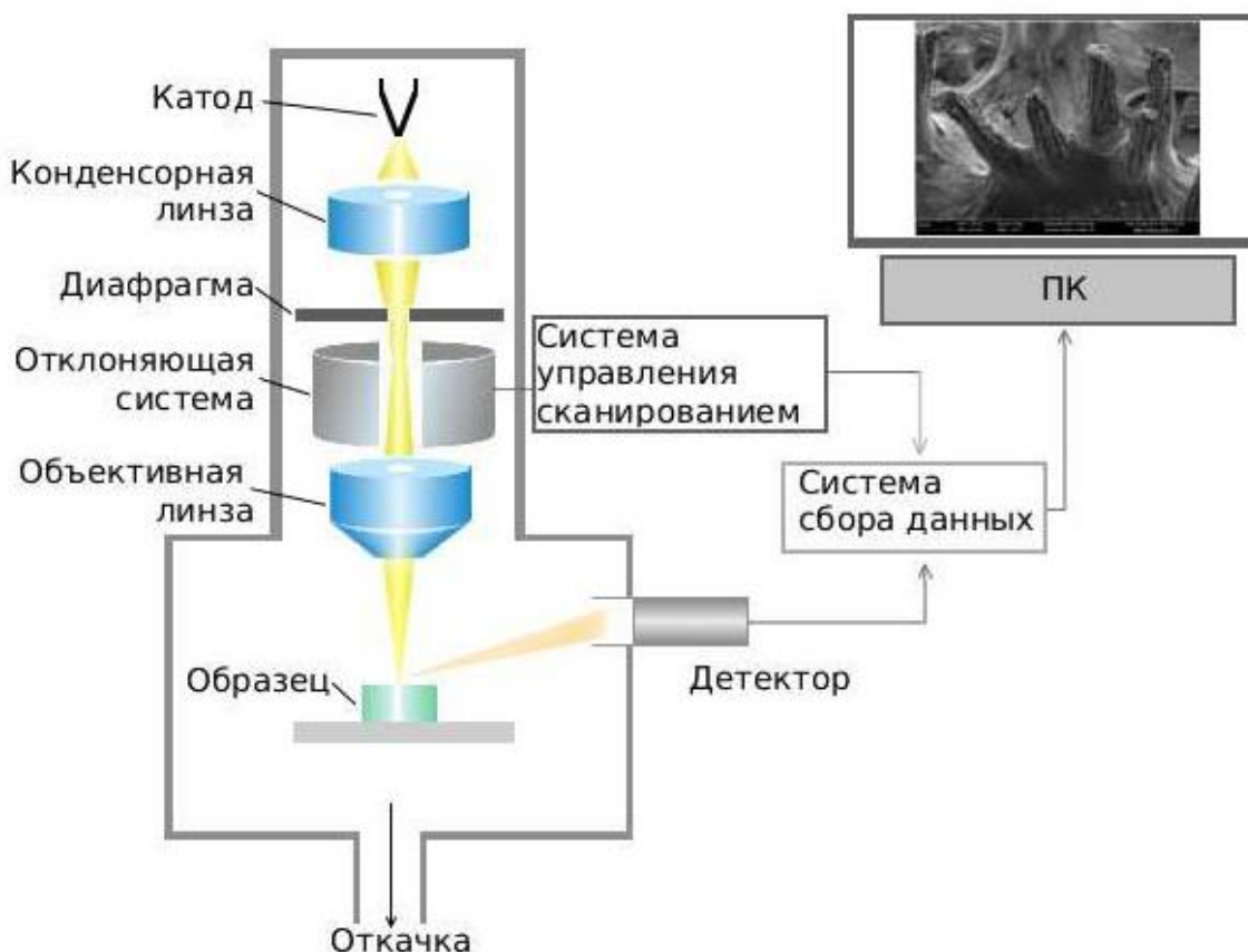
Рисунок 2.2 – Принципиальная схема устройства сканирующего электронного микроскопа [84]
